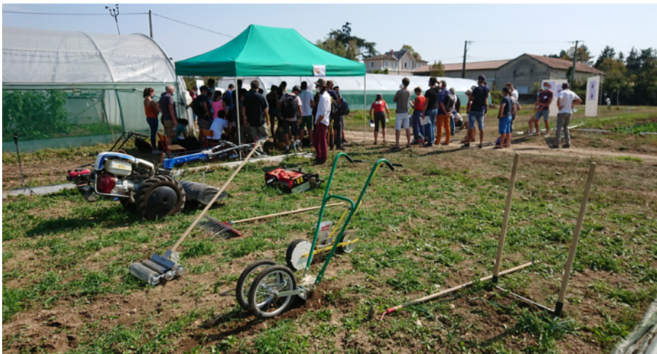
Démonstration de matériel autoconstruit pour la pose de goutte à goutte enterré, par Emmanuel Perrier, maraîcher en Ardèche.
